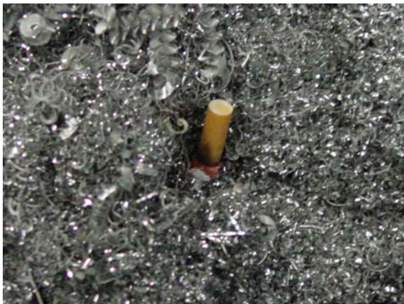
Bild 6: Zündquellen im Spänebehälter [6]
